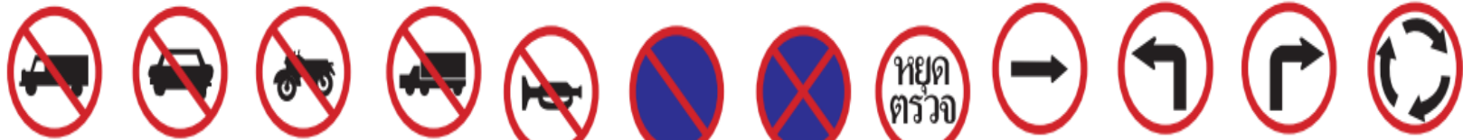
1-9 ห้ามรถบรรทุก 1-10 ห้ามรถยนต์ 1-11 ห้ามรถ จักรยานยนต์ 1-12 ห้ามรถพ่วง 1-21 ห้ามใช้เสียง 1-22 ห้ามจอด 1-23 ห้ามหยุดรถ 1-24 หยุดตรวจ 1-33 รถเดินทางเดียว ไปทางขวา 1-34 ให้เลี้ยวซ้าย 1-35 ให้เลี้ยวขวา 1-36 วงเวียน
