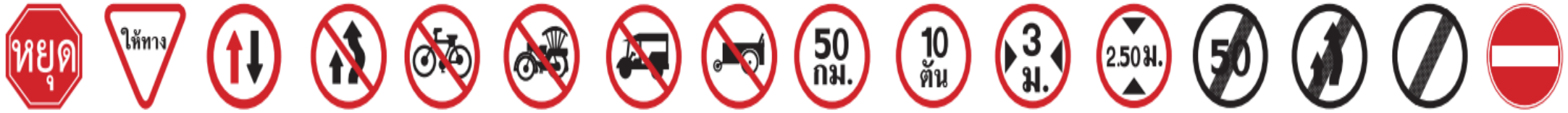
1-1 หยุด 1-2 ให้ทาง 1-3 ให้รถสวนทาง มาก่อน 1-4 ห้ามแซง 1-13 ห้ามรถ จักรยาน 1-14 ห้ามรถสามล้อ 1-15 ห้ามรถยนต์สามล้อ 1-16 ห้ามล้อ เลื่อนลากเข็น 1-25 จำกัดความเร็ว 1-26 จำกัดน้ำหนัก 1-27 จำกัดความกว้าง 1-28 จำกัดความสูง 1-37 สุดเขตบังคับ ความเร็ว 1-38 สุดเขตบังคับ ห้ามแซง 1-39 สุดเขตบังคับ 1-40 เดินรถ ทางเดียว
