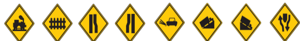
2-25 ทางข้ามรถไฟ (ไม่มีเครื่องกั้นราง) 2-26 ทางข้ามรถไฟ (มีเครื่องกั้นราง) 2-27 ช่องจราจรลดลง 2-28 ช่องจราจรลดลง 2-37 ทางร่วน 2-38 ทางขึ้นลาดชัน 2-39 ทางลงลาดชัน 2-40 ทางคู่ข้างหน้า
