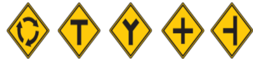
2-11 วงเวียนข้างหน้า 2-12 เครื่องหมายเตือนทางแยก 2-13 เครื่องหมายเตือนทางแยก 2-14 เครื่องหมายเตือนทางแยก 2-15 เครื่องหมายเตือนทางแยก
