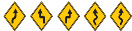
2-6 ทางโค้งกลับเริ่มขวา 2-7 ทางโค้งกลับรัศมีแคบเริ่มซ้าย 2-8 ทางโค้งกลับรัศมีแคบเริ่มขวา 2-9 ทางคดเคี้ยวเริ่มซ้าย 2-10 ทางคดเคี้ยวเริ่มขวา
