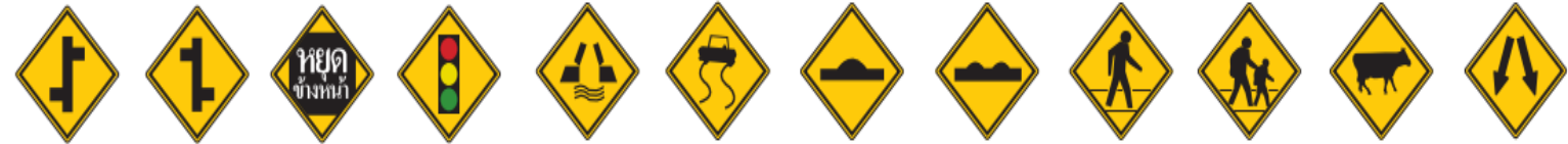
2-21 เครื่องหมายเตือนทางแยก 2-22 เครื่องหมายเตือนทางแยก 2-23 หยุดข้างหน้า 2-24 สัญญาณไฟ 2-33 สะพานเปิดได้ 2-34 ทางลื่น 2-35 รถกระโดด 2-36 ทางขรุขระ 2-45 คนข้ามทาง 2-46 โรงเรียนระวางเด็ก 2-47 ระวังสัตว์ 2-48 เครื่องหมายลูกศรคู่
